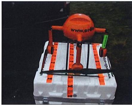
Der sog. Oktokopter (mit eingeklappten Rotorflügeln)
